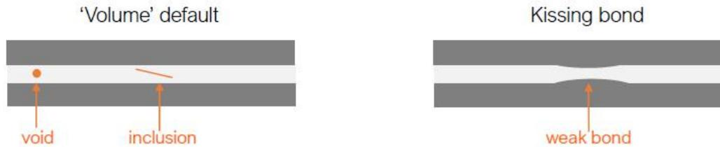
复合材料的粘接缺陷
