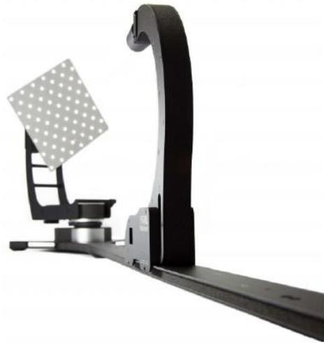
属于紧凑型方案，适合中型尺寸发光产品的测试，被测样品尺寸：35cm-300cm;
